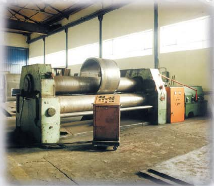
Rodillo de Curvado Ajial 397 / Bending Roll Ajial 397
